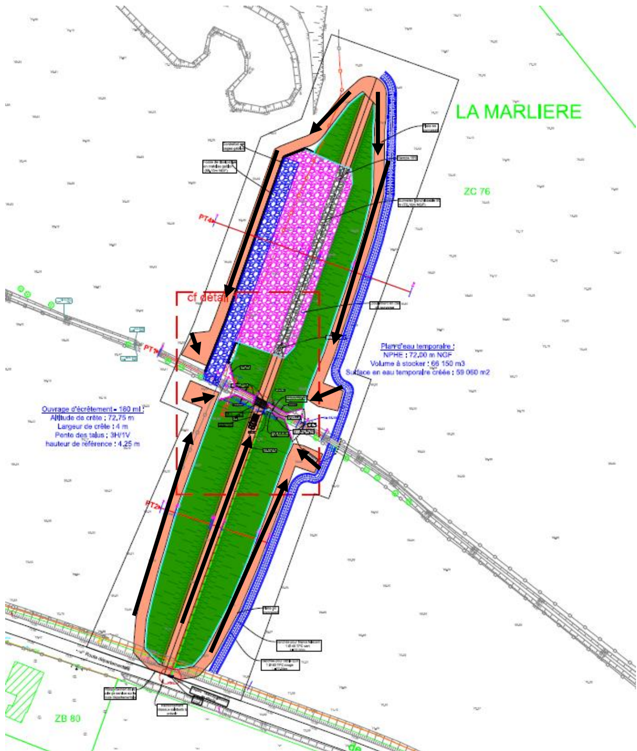
Figure 5 : Ouvrage de Beaugies-sous-Bois -- Sens du parcours des inspections (en noir)
